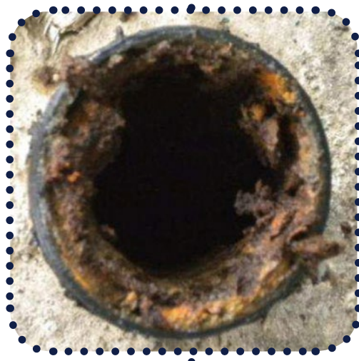
Figura 2. Imágenes que muestran la sección transversal de tuberías que contienen biofilm.
